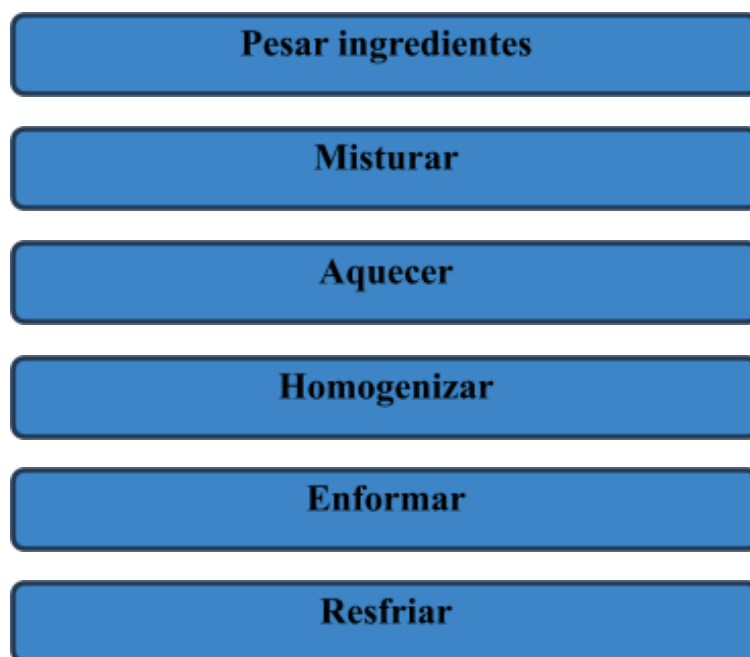
Figura 2 - Etapas de processamento da gelatina.
