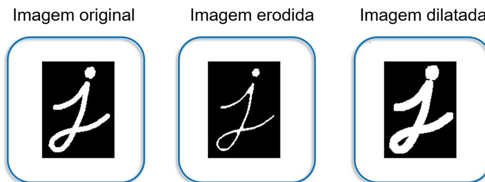
**Figura 2.1:** a) Imagem original. b) Imagem erodida. c) Imagem dilatada. Figura extraída da biblioteca gráfica OpenCV.
