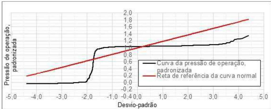
Figura 64 - Curva da pressão de operação padronizada e reta de referência da curva normal. (a) Etapas 03 e 04; (b) Etapas 05, 06 e 07; (c) Etapas 08, 09, 10 e 11
