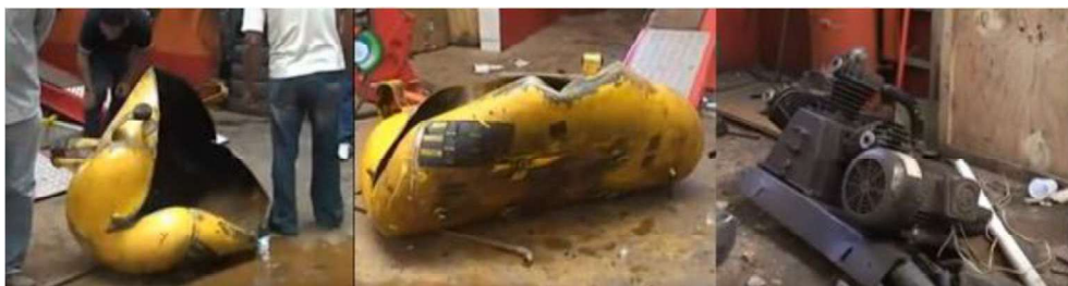
Figura 12 - Situação em que ficou o vaso de pressão após o acidente
