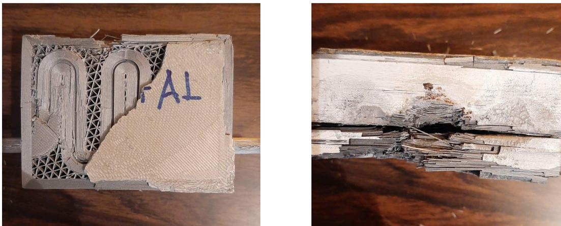
Figura 43 – O interior do molde de PLA + AL após a injeção – [imagem do autor]
