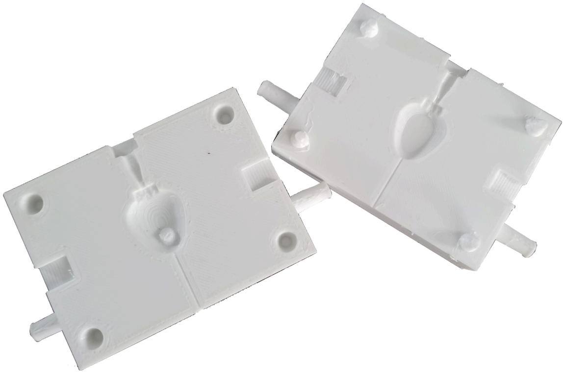
Figura 30 – Moldes impressos em resinas PRO e AT respectivamente – [imagem do autor]
