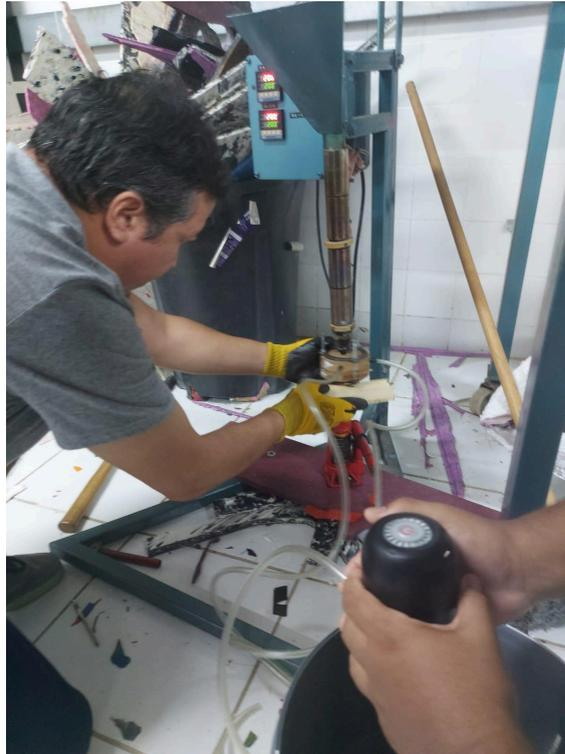
A injetora do laboratório PP opera com um sistema um pouco arcaico ou artesanal: o molde para ser injetado precisa ser apoiado sobre uma base de madeira, que por sua vez é colocada sobre um macaco hidráulico que regula sua altura para levar o molde até o bico de injeção da injetora. Em contrapartida, o sistema de aquecimento é regulado eletronicamente (um sistema superior ao da injetora Vulcano).
