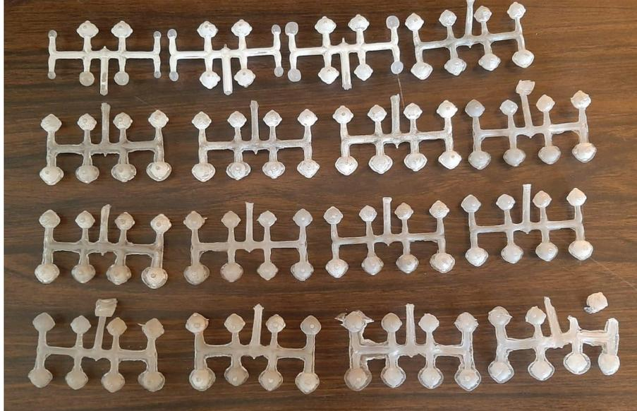
Figura 50 – Molde de resina dental após as injeções – [imagem do autor]
