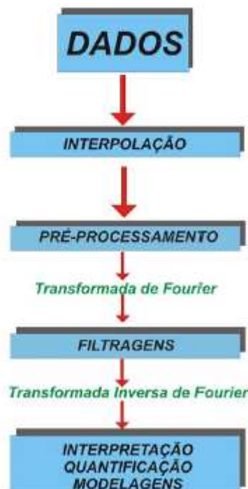
Figura 49 - Esquema da sequência de etapas empregada no processamento dos dados gravimétricos. Fonte: Oliveira (2008).
