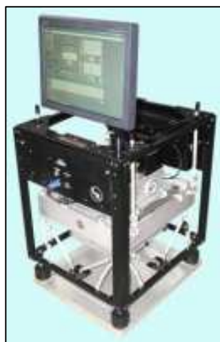
Figura 27 - Modelo de gravímetro marítimo. Fonte: http://www.lacosteromberg.com
