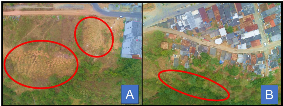
Figura 20: Sinais de deslizamento e retirada da vegetação (A) e Erosão de grande proporção próxima às áreas urbanas (B).
