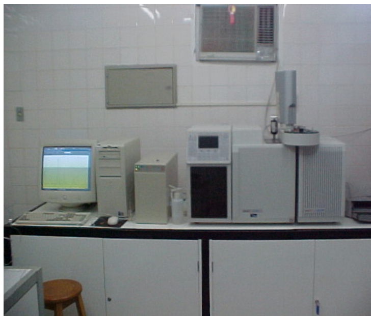
Figura 2. Conjunto do sistema de aquisição de dados composto de cromatógrafo a gás (Varian 3800) equipado com detector de condutividade térmica (TCD), detector de ionização de chama (FID) e espectrofotômetro de massa (SMD).
