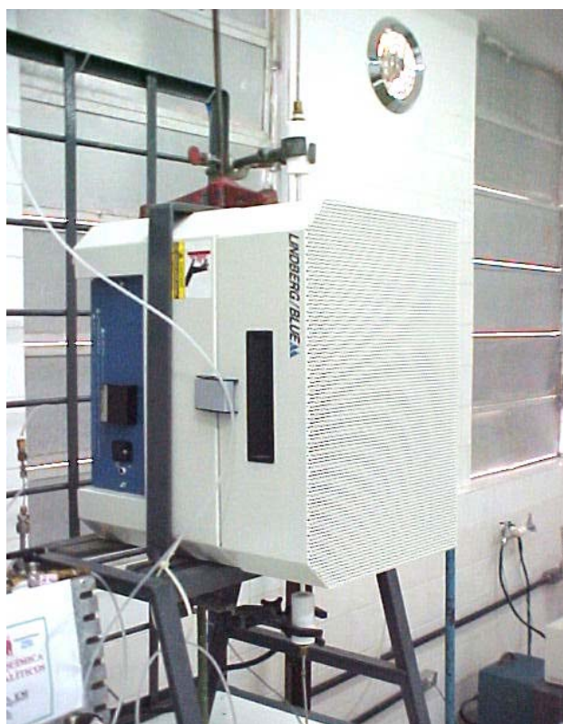
Figura 3. Unidade experimental em reator de leito fixo composta de forno e micro reator de quartzo.
