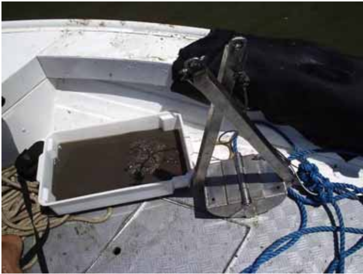
Figura 14 Amostrador pontual van Veen e amostra de sedimento de fundo.
