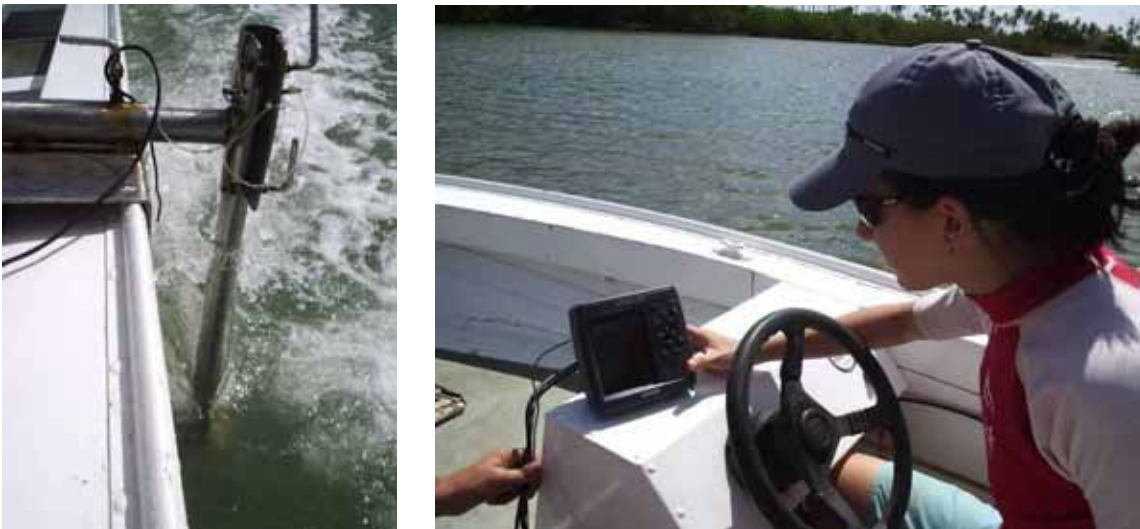
Figura 17 Coleta de dados de profundidade através do transdutor acoplado à embarcação e armazenamento na ecossonda.
