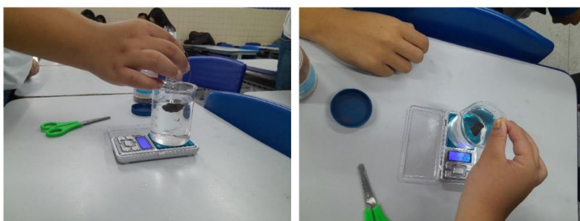
Fig. 39.Determinação da massa de líquido deslocado
