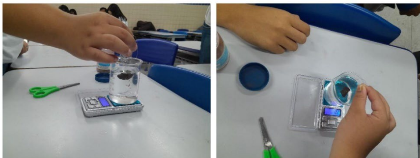
Fig. 22.Determinação da massa de líquido deslocado
