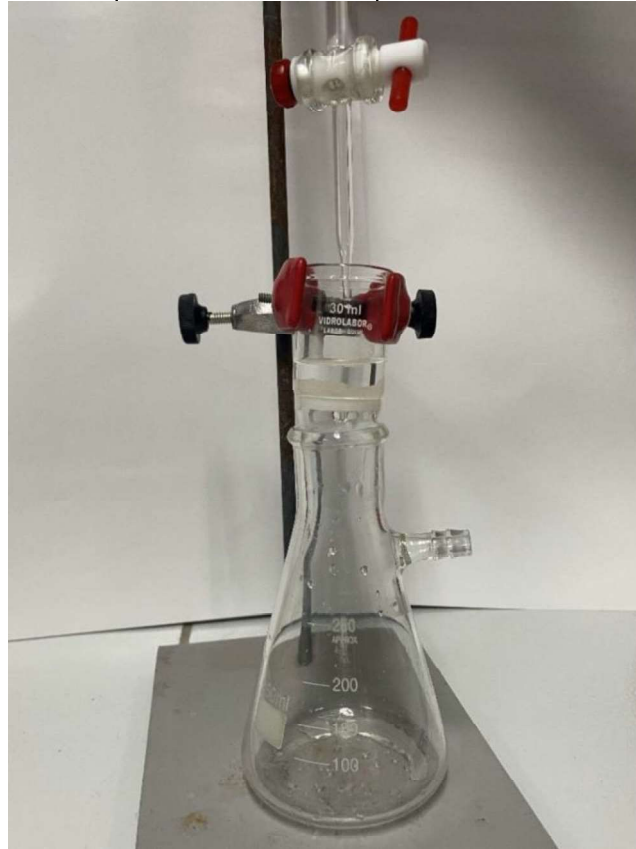
Figura 9. Procedimento para o tratamento do biopolímero com fluxo contínuo com água.
