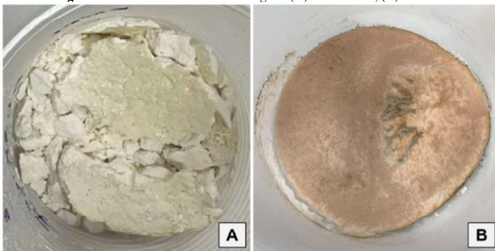
Figura 10. Amido extraído da batata inglesa (A) não oxidado; (B) oxidado.
