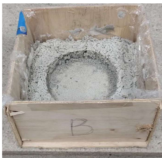
Figura 48 - Célula B para ensaio de Penetração. Fonte: Autor
