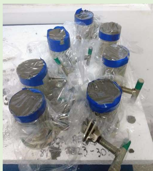
Figura 11 - Moldagem Concreto Celular
