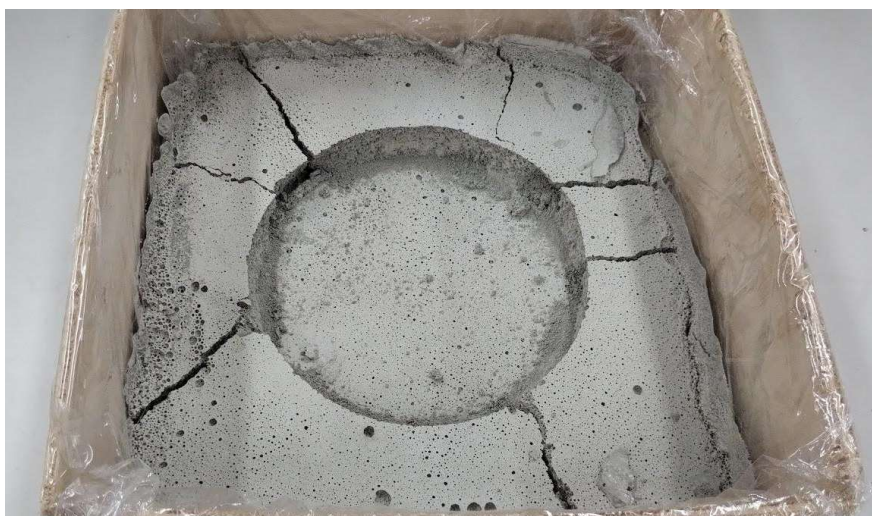
Figura 47 - Célula C para ensaio de compressão. Fonte: Autor.
