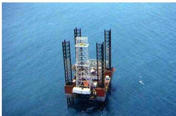
Figura 2.02 – Plataforma Auto-Elevatória North Star I
