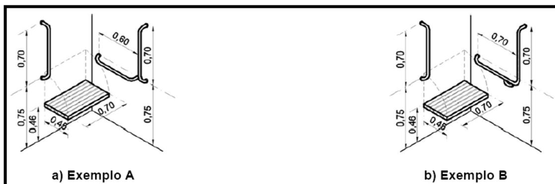
Figura 2.40 – Perspectiva do boxe com as barras de apoio.
