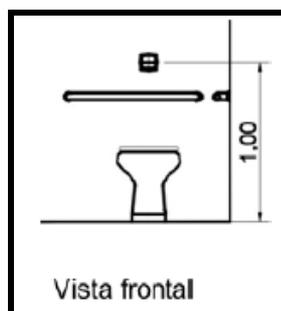
Figura 2.27 - Altura de acionamento da descarga.
