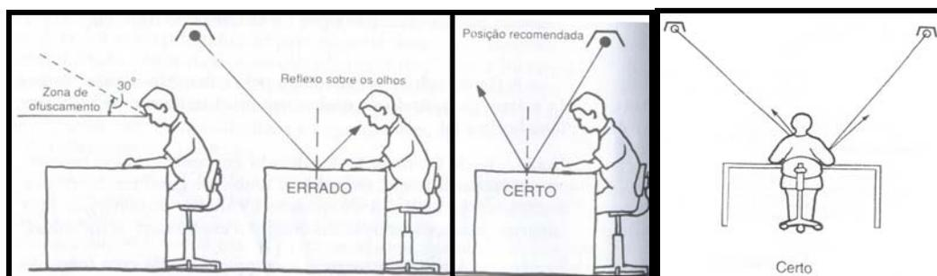
Figura 2.4 - Posicionamento das luminárias
