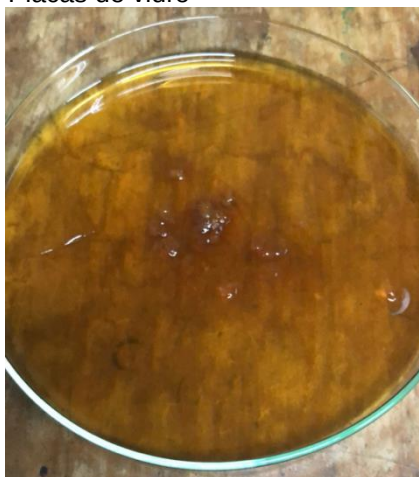
Figura 37 – Gel do eletrólito de Agarose com Lactato de Colina em Placas de vidro
