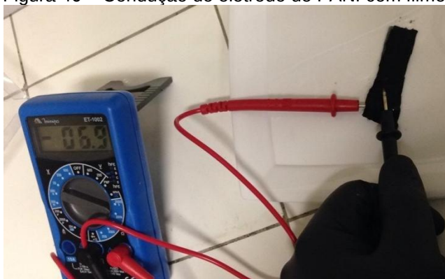
Figura 46 – Condução do eletrodo de PANI com filme de Agarose
