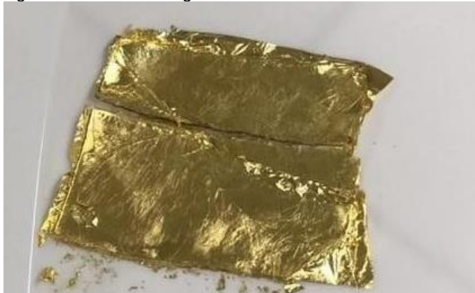
Figura 36 - Filme de agarose com eletrodos de ouro – vista superior
