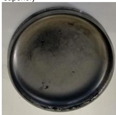
Figura 40 – Filme de Agarose contendo 1,0 g de Grafite (vista superior)
