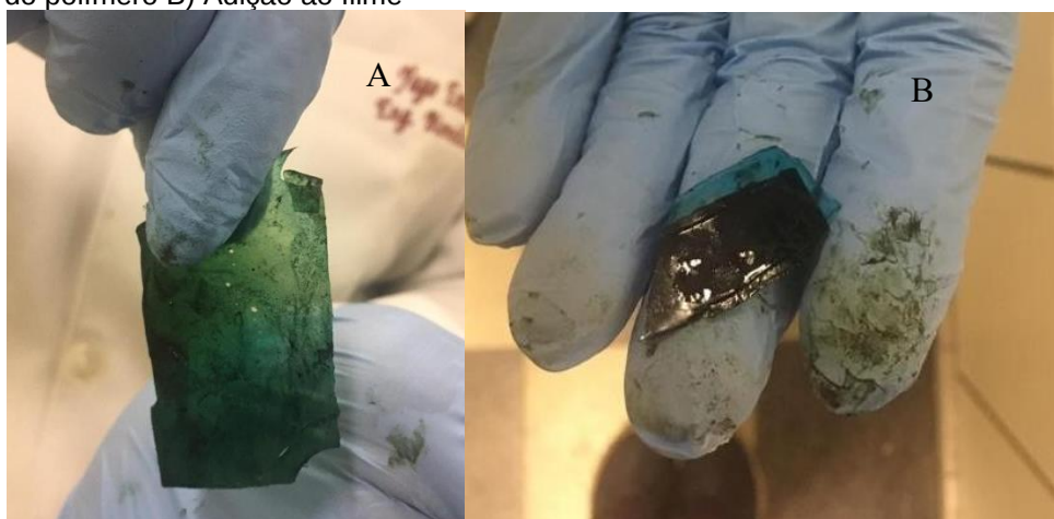
Figura 45 – Filme de agarose associado ao eletrodo de agarose mais PANI: A) Disposição do polímero B) Adição ao filme
