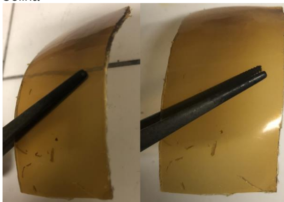
Figura 38 – Flexibilidade do filme/eletrólito de Agarose com Lactato de Colina
