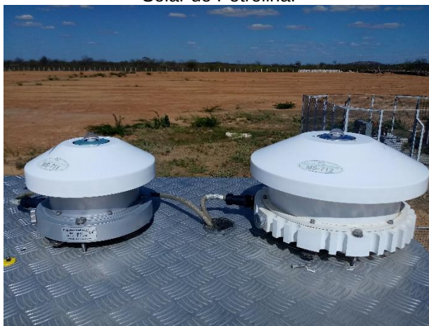
Figura 12 – Espectrorradiômetros EKO MS-711 (à esquerda) e EKO MS-712 (à direita) da Plataforma Solar de Petrolina.
