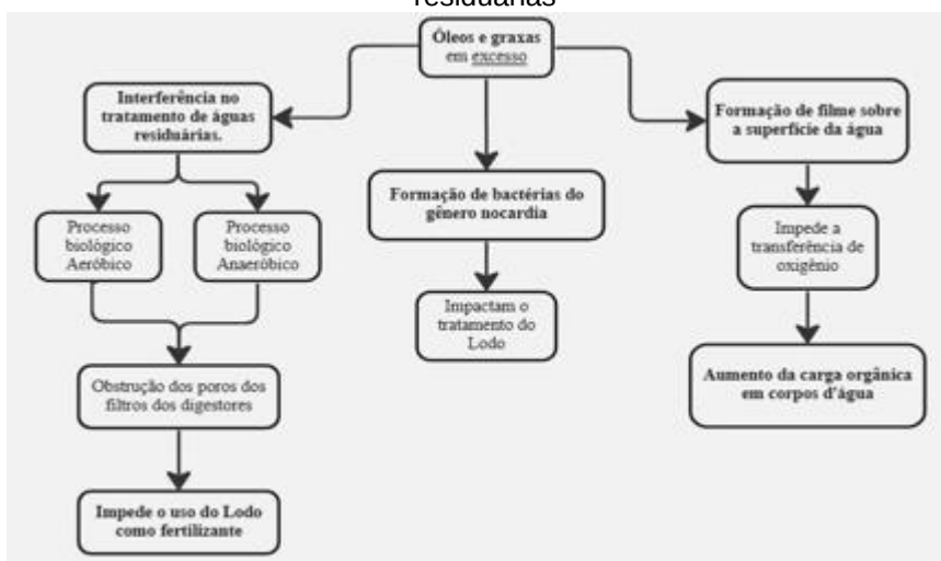
Figura 11 – Fluxograma dos principais impactos ambientais causados no tratamento de águas residuárias
