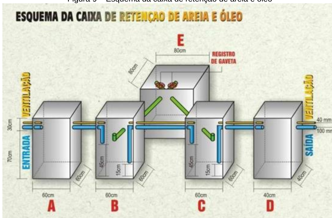
Figura 9 – Esquema da caixa de retenção de areia e óleo
