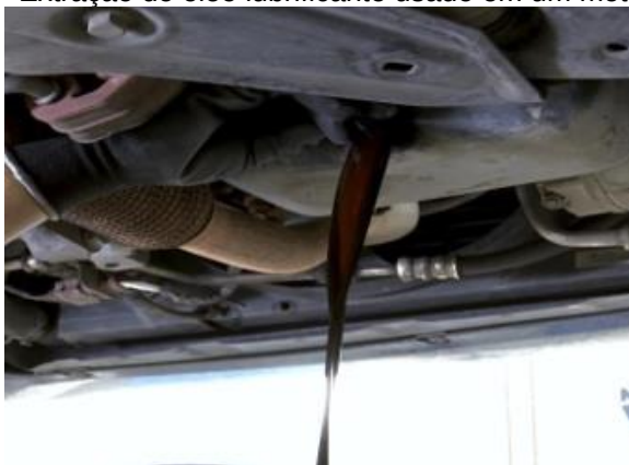
Figura 4 – Extração do óleo lubrificante usado em um motor veicular
