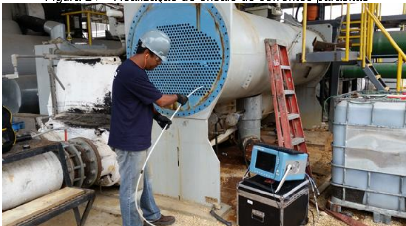
Figura 14 – Realização de ensaio de correntes parasitas
