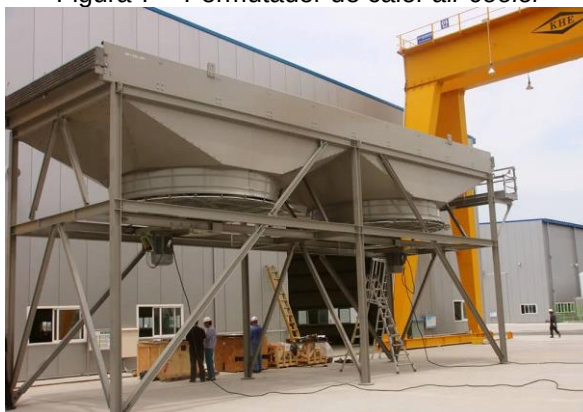
Figura 7 – Permutador de calor air cooler
