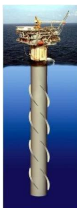
Figura 12: Esquema de uma Spar suportando uma plataforma de petróleo.
