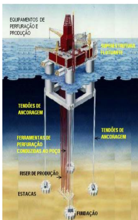
Figura 16: Sistema com ancoragem vertical.
