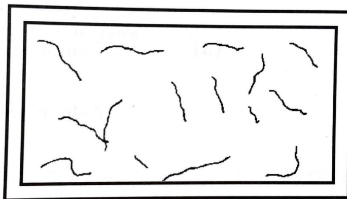
Figura 10 - Fissura mosaico em laje
