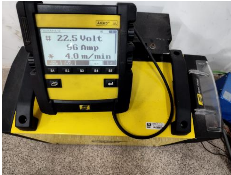
Figura 18 - Máquina configurada com parâmetros selecionados.
