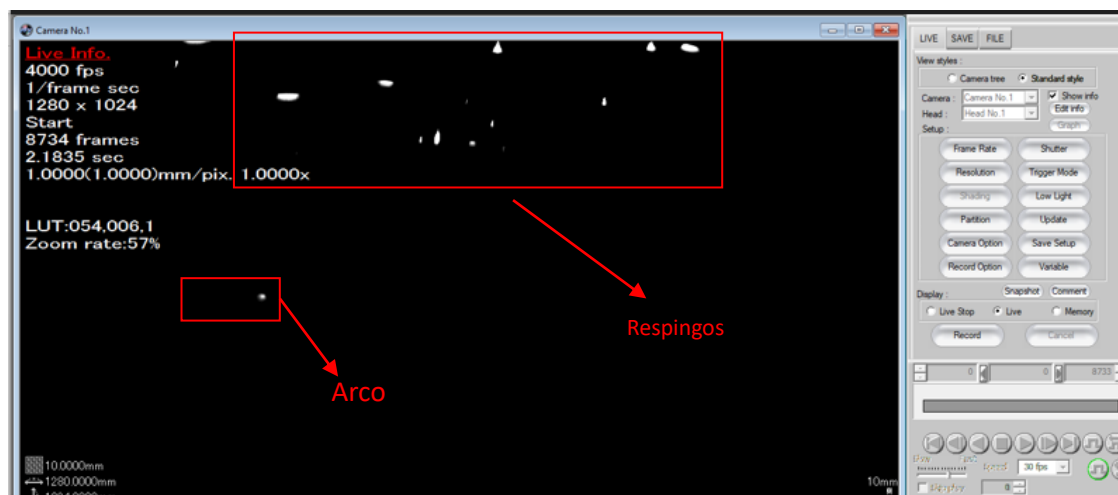
Figura 27 - Captação do teste 1 no software por solda curto-circuito com filtro 10.
