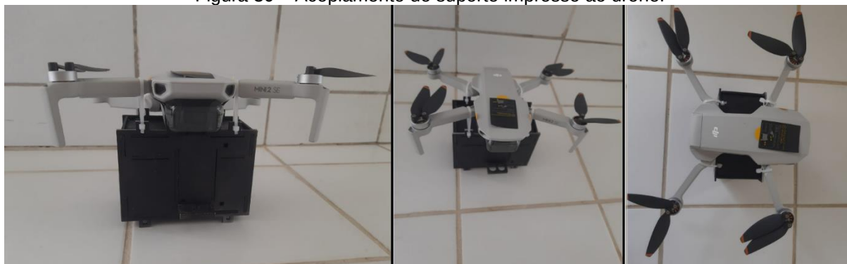
Figura 30 – Acoplamento do suporte impresso ao drone.
