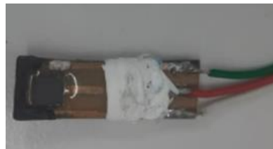
Figura 23 – Eletrodo impresso fabricado em laboratório.
