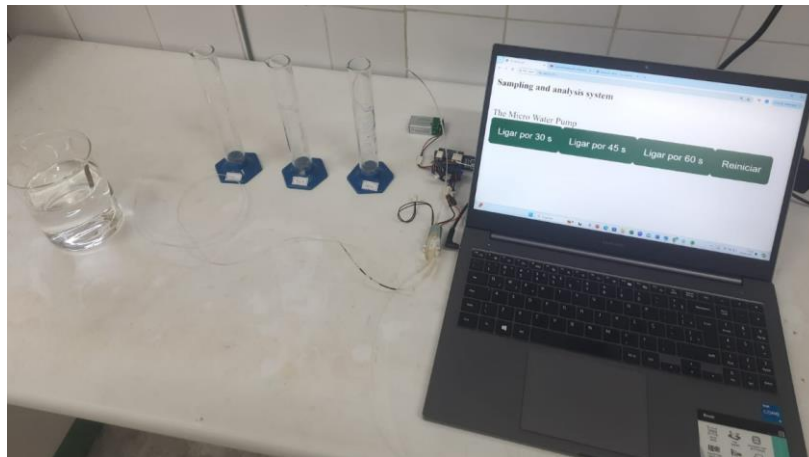
Figura 13 – Ensaio para medição da vazão da microbomba d'água.
