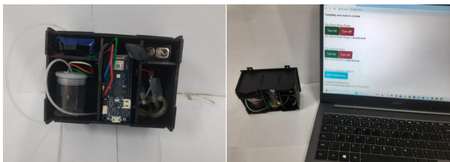
Figura 34 – Montagem do circuito na peça impressa em 3D e envio de dados via WiFi.
