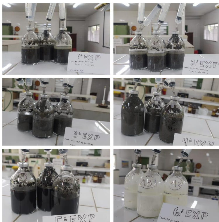
Figura 17 - Biodigestores de proporções (1/8 – 4/8) e brancos de Lodo de ETE e de Amido de Milho.
