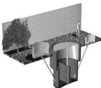
Figura 2 – Esquema de biodigestor modelo indiano.
