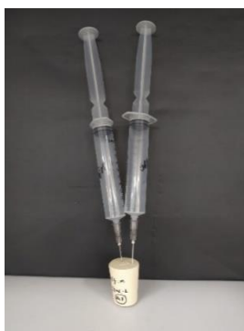
Figura 18 - Método de Armazenamento de gás, Seringas cheias introduzidas em tampa de borracha.
