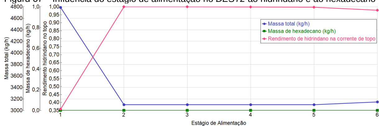
Figura 37 – Influência do estágio de alimentação no DEST2 ao hidrindano e ao hexadecano
