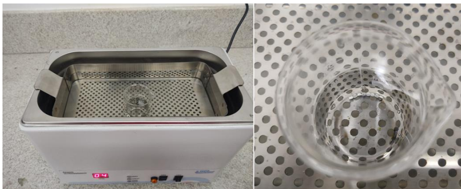
Figura 22 - Limpeza das amostras por ultrassom para ensaios de oxidação em altas temperaturas.
