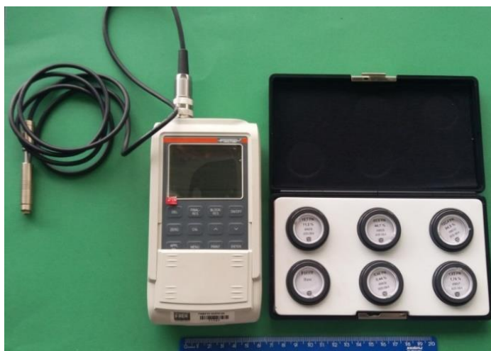
Figura 10 - Ferritoscópio utilizado para medição de percentagem de ferrita nas camadas de revestimento.
