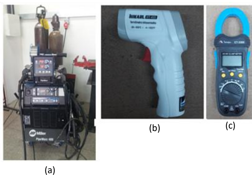
Figura 9 - equipamentos utilizados durante a soldagem dos revestimentos, (a) Fonte multiprocesso (b) Pirômetro e (b) Multímetro.
