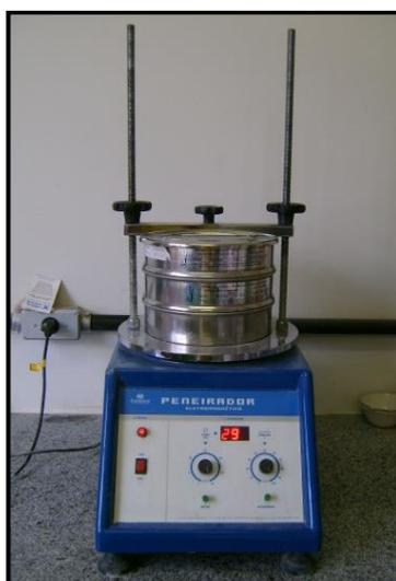
Figura 6 - Peneirador eletromagnético
