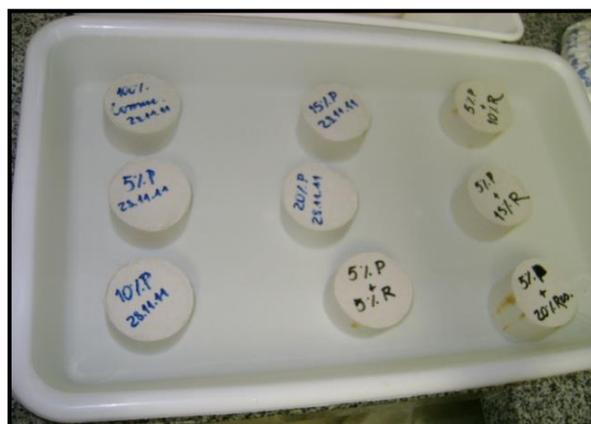
Figura 13 - Ensaio de absorção por imersão
