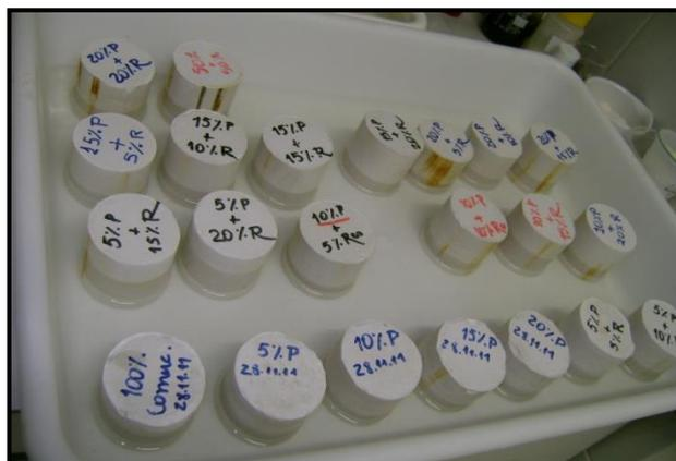
Figura 12 - Absorção de água por capilaridade
