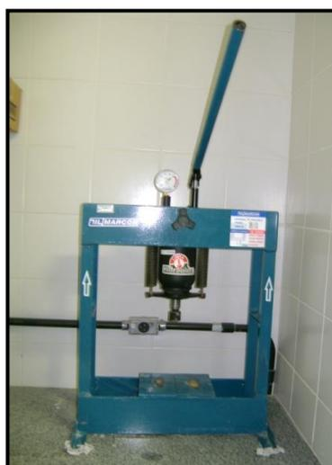
Figura 10 - Prensa hidráulica
