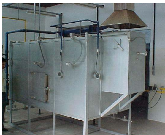
Figura 3.2 – Câmara de combustão utilizada nas exposições
