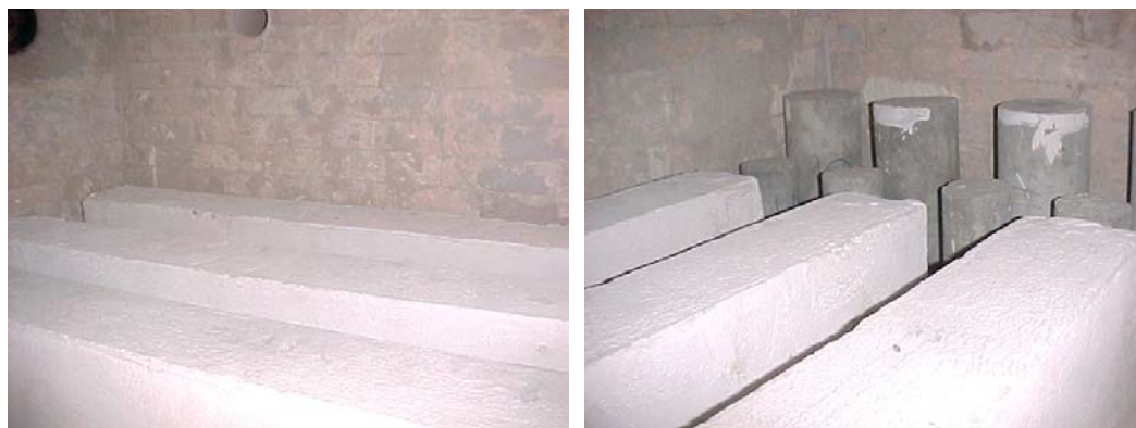
Figura 3.9 – Distribuição das vigas e corpos-de-prova para exposição
