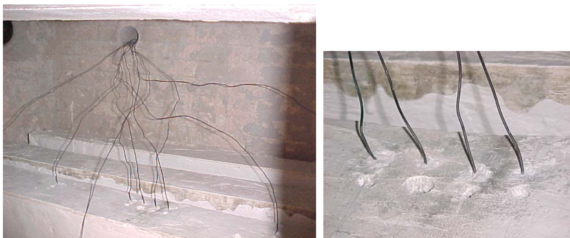
Figura 3.7 – Termopares localizados no interior da peça estrutural
