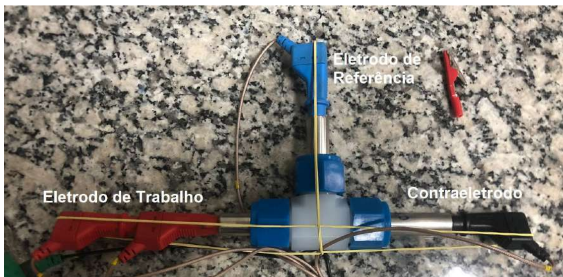
Figura 17 – Célula Swagelok de três eletrodos.
