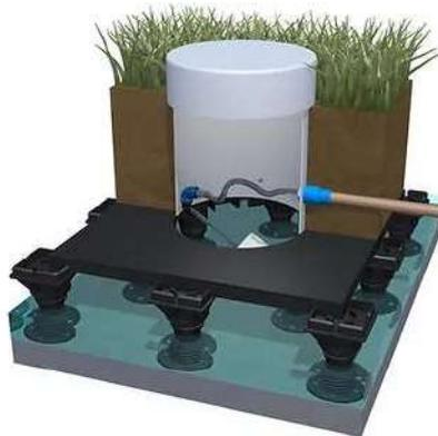
**[Figura 95]** Placas de piso elevado sobre pedestais de altura regulável e reservatório temporário de água
