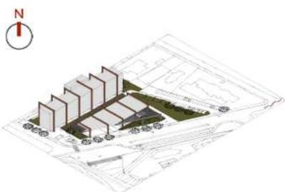
**[Figura 57]** Tanto o bloco de salas quanto o pavilhão seguem a mesma modulação de estrutura e, assim como a alameda, gera conexão entre os dois blocos; redução e simplificação da laje do pavilhão através da estrutura dos pergolados, gerando integração com as áreas verdes.
