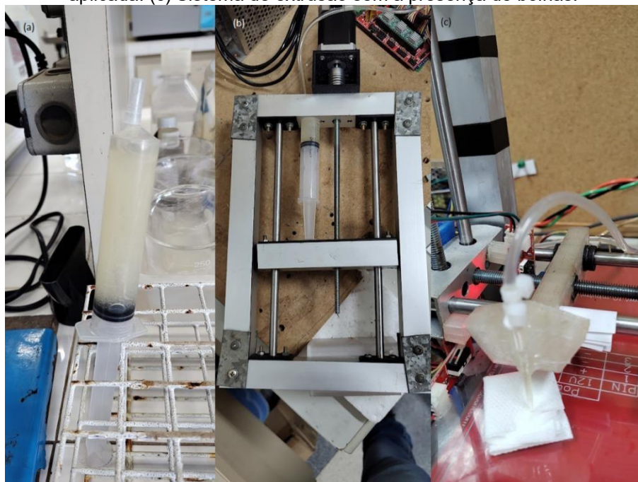
Figura 22 – (a) Seringa de biomaterial com bolhas em seu interior. (b) Seringa com pressão aplicada. (c) Sistema de extrusão sem a presença de bolhas.
