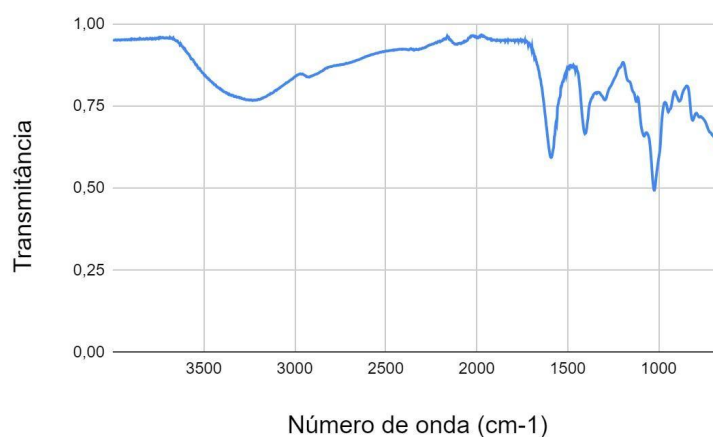
Figura 25 – Gráfico do espectro de absorção na região do infravermelho com transformada de Fourier do alginato de sódio (pó).
