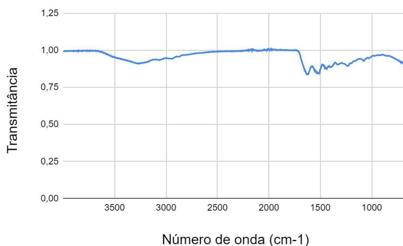
Figura 26 – Gráfico do espectro de absorção na região do infravermelho com transformada de Fourier da gelatina.
