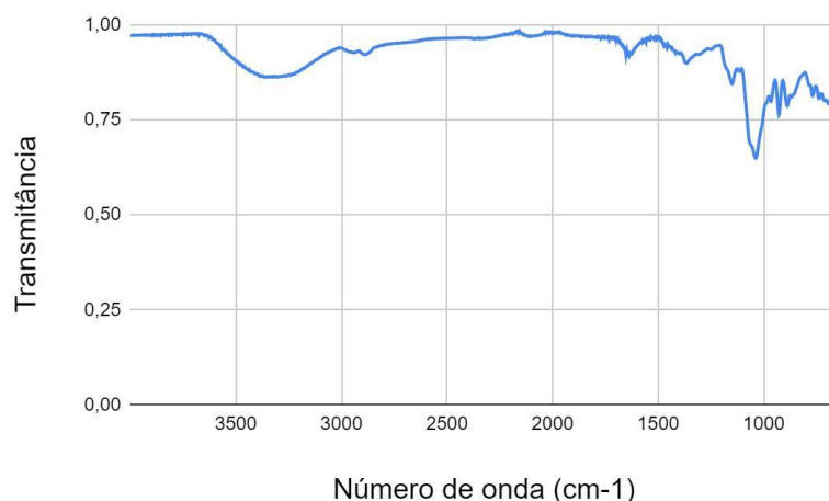
Figura 27 – Gráfico do espectro de absorção na região do infravermelho com transformada de Fourier da agarose.
