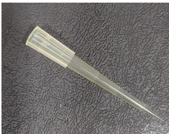
Figura 21 – Ponteira de micropipeta utilizada como bico extrusor da impressora.
