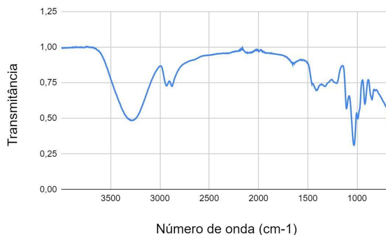
Figura 28 – Gráfico do espectro de absorção na região do infravermelho com transformada de Fourier do glicerol.
