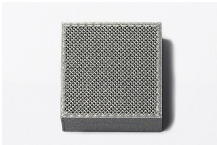
Figura 8 – Estrutura interna de peça impressa por FDM.
