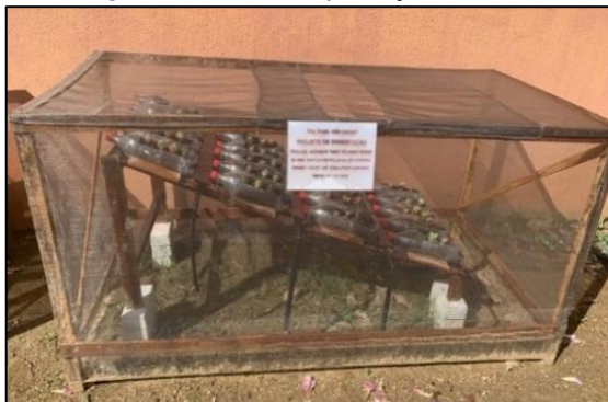
Figura 9- Telhado verde ecológico com tela de proteção contra interferência do meio externo
