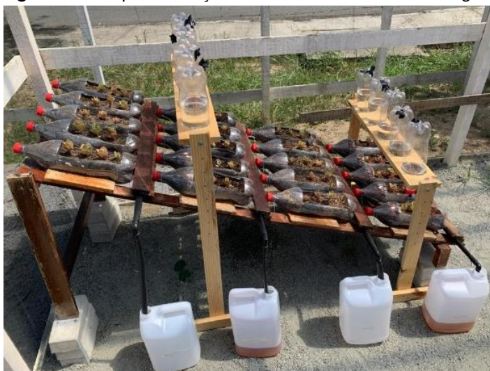
Figura 17- Esquematização real do telhado verde ecológico
