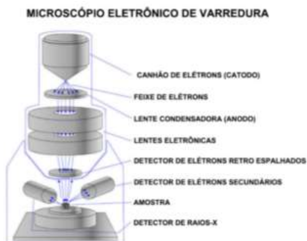
Figura 12: Componentes de um microscópio eletrônico de varredura
