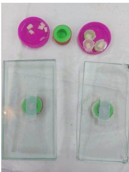
**Figura 2** - Confeção dos corpos de prova.
