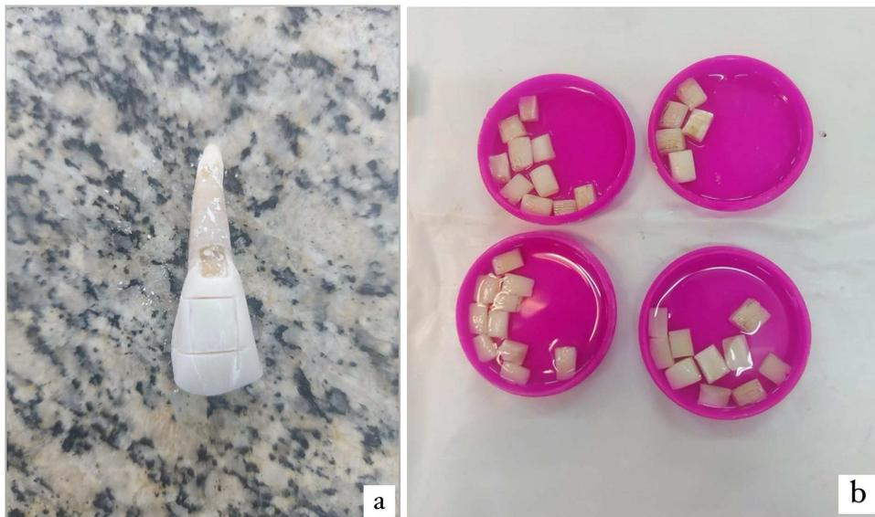
**Figuras: 1a** - Dente bovino seccionado na vestibular. **1b** - Fragmentos medindo 10mm x 10mm.
