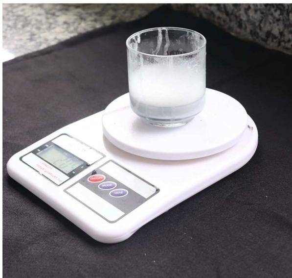
**Figura 7** - Mistura dos géis com água destilada na proporção de 1:2, ou seja, 90g de gel para 180 mL de água destilada.
