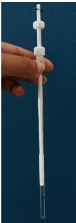
Figura 2 – Tubo de 5mm com o dispositivo New Era instalado.
