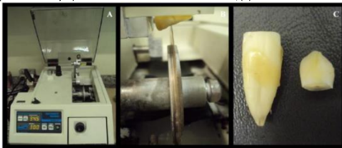
Figura 1 – Secção da coroa dentária no limite da junção amelocementária (A) cortadeira metalográfica; (B) secção da coroa na junção amelocementária com disco diamantado; (C) raiz seccionada da coroa.
