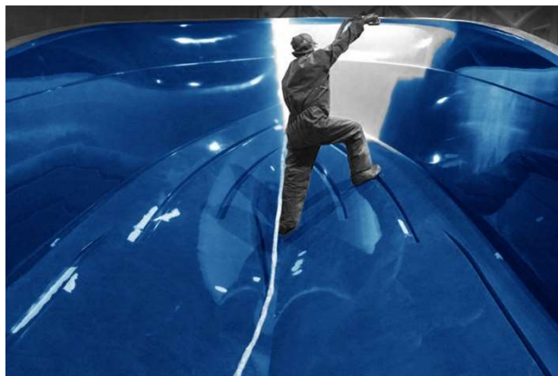
Figura 9: Aplicação de gelcoat no molde do casco de um iate.
