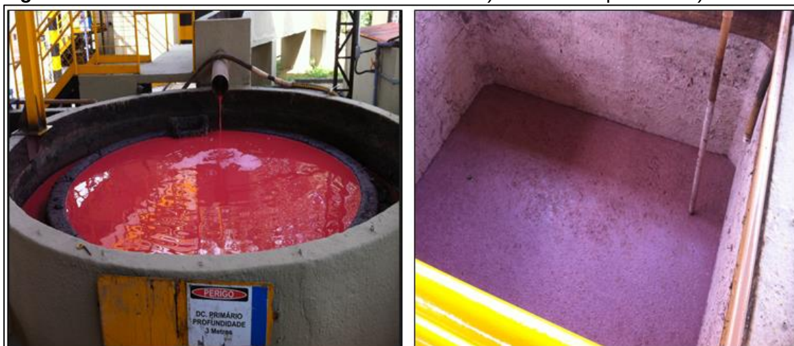
Figura 101: Efluente bruto da indústria de abrasivos A) decantador primário B) flotador
