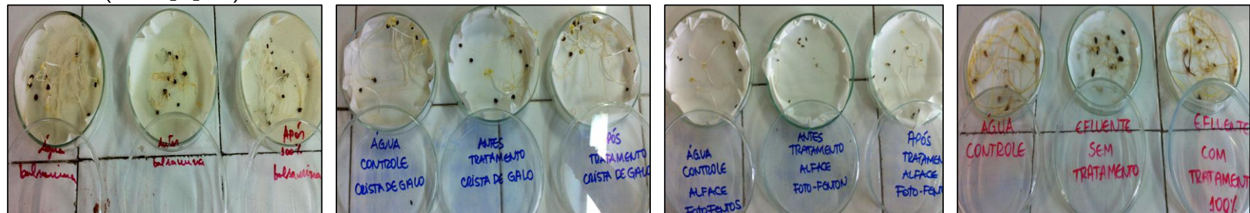
Figura 93: Sementes de balsamina, crista de galo, alface e trigo, respectivamente, submetidos ao efluente antes e após tratamento( \text{Fe}^{2+}/\text{H}_2\text{O}_2/\text{UV} ).
