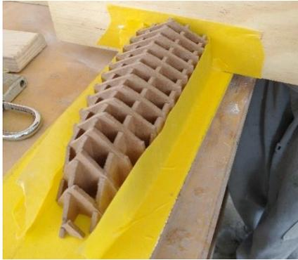
Figura 19 – Foto após expansão do PU.
