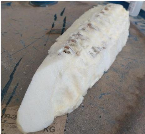
Figura 21 - Aplicação de resina após lixamento.
