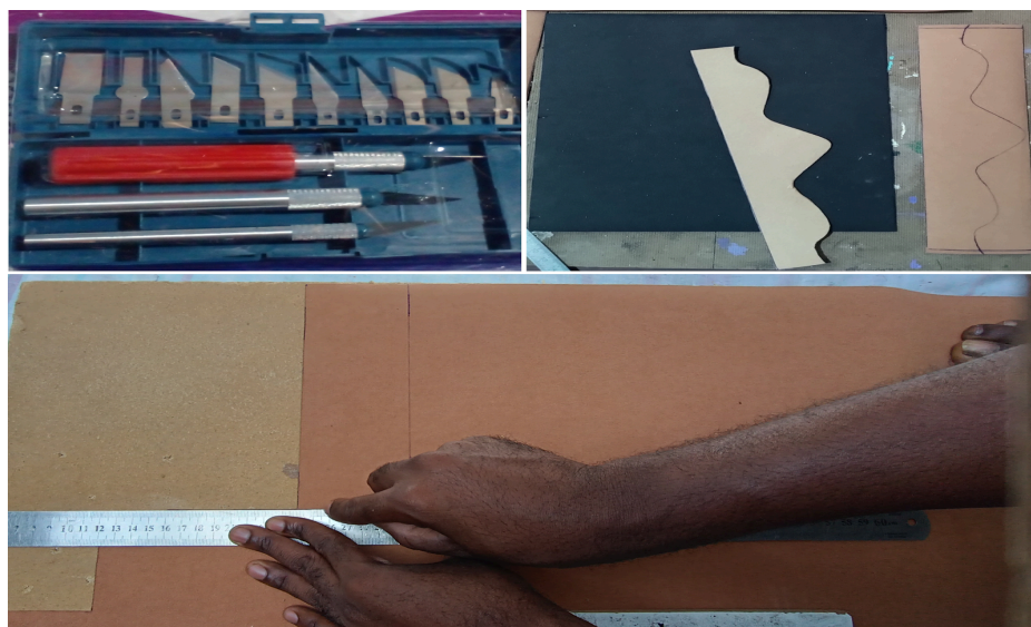
Figura 32 - Processo de corte, gabarito e ferramentas de corte
