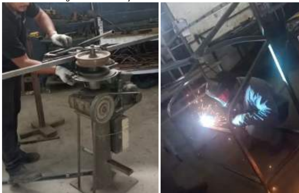
Figura 33 – Fabricação da fruteira central: linha smart
