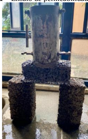
Figura 11 – Ensaio de permeabilidade adaptado
