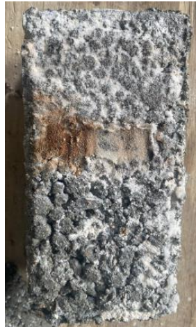
Figura 8 – Desgaste provocado no bloco devido ao ensaio de resistência à abrasão
