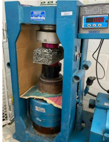
Figura 6 – Ensaio de resistência à compressão dos blocos
