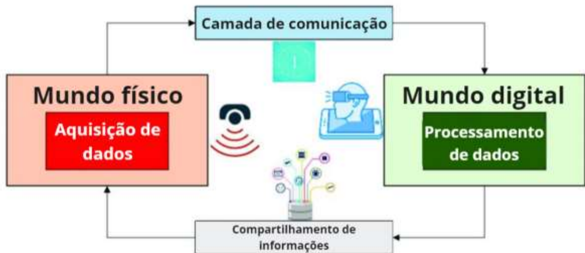
Figura 6 - Relação entre gêmeo digital e o modelo físico real.
