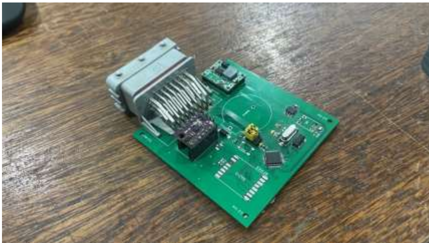
Figura 21 - Montagem em hardware final da ECU dianteira.
