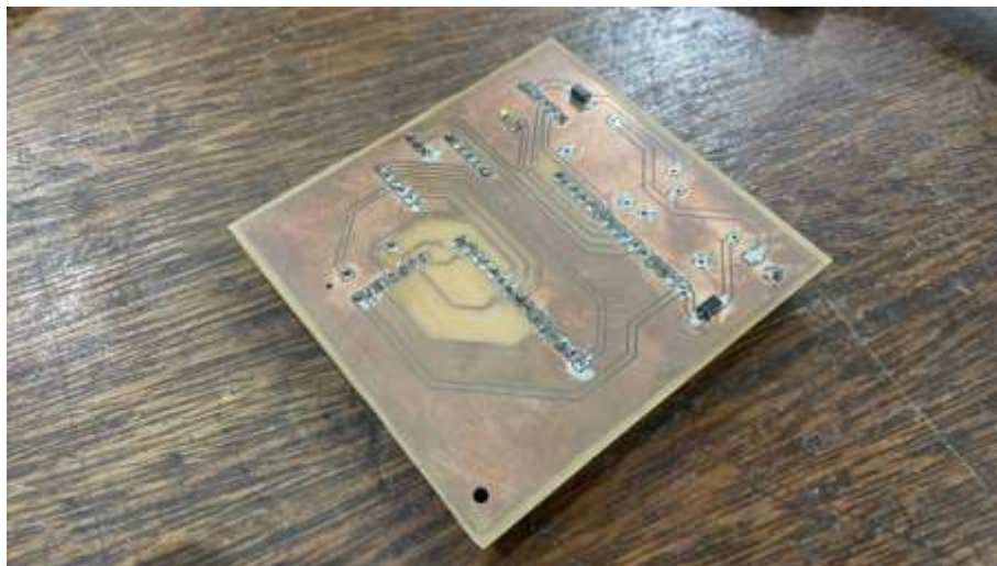
Figura 19 - Placa por fabricação manual de corrosão.
