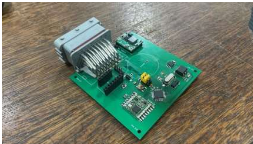
Figura 22 - Montagem em hardware final da ECU traseira.
