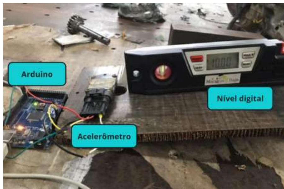
Figura 18 - Prototipação do IMU , validação e calibração do sensor.
