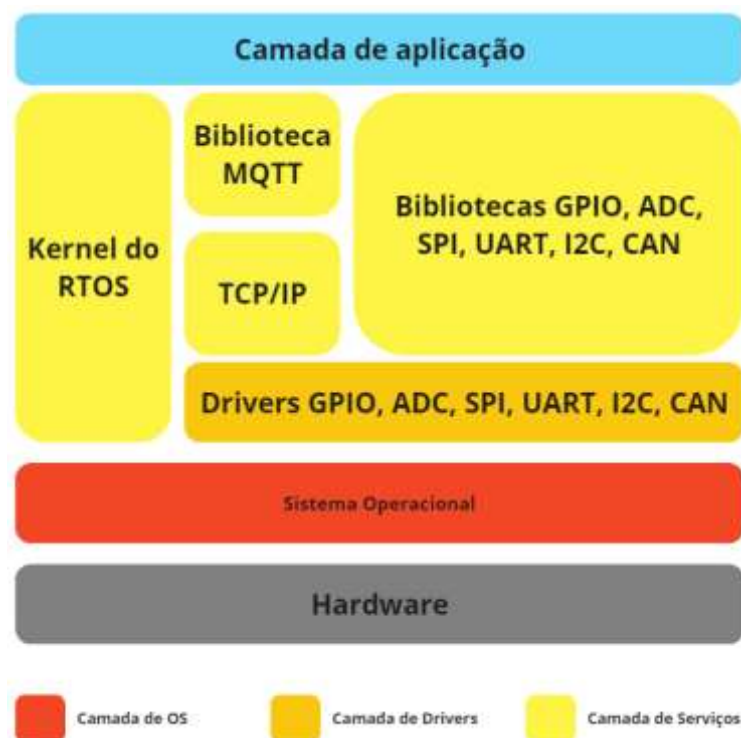
Figura 8 – Arquitetura de software para as ECUs desenvolvidas.
