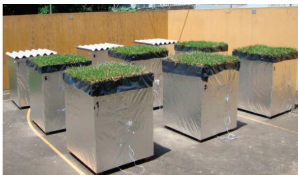
Figura 4 - Módulos experimentais construídos utilizando 3 tipos de cobertas diferente
