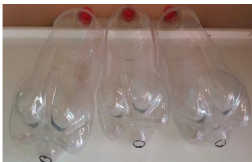
Figura 22 - Furos nas garrafas para colocação das conexões
