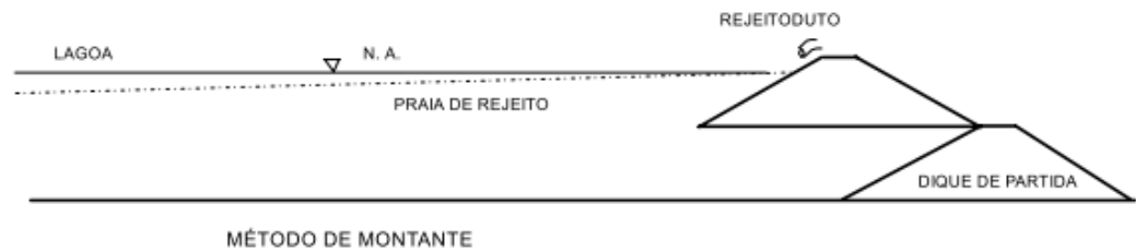
Figura 8 - Método construtivo de montante.
