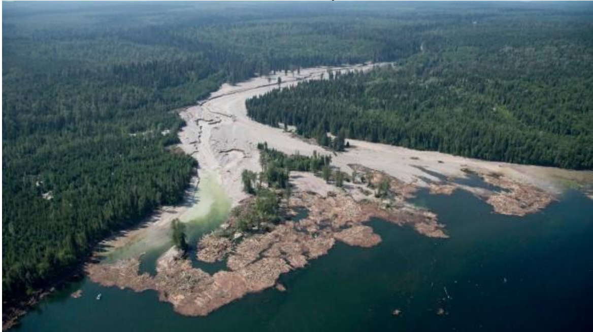
Figura 15 - Mancha de rejeitos no Lago Quesnel oriunda do rompimento da barragem de Mount Polley.
