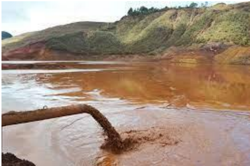
Figura 2 - Disposição de rejeitos em polpa.
