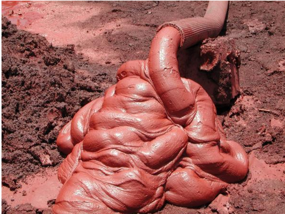
Figura 4 - Disposição de rejeitos em pasta
