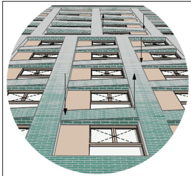
Figure 32 - Ondulation sur la façade du bâtiment D2
