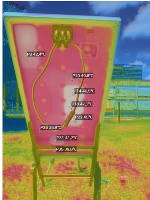
Termograma retirada a punho às 11:42h da traseira do módulo com emissividade calibrada.
