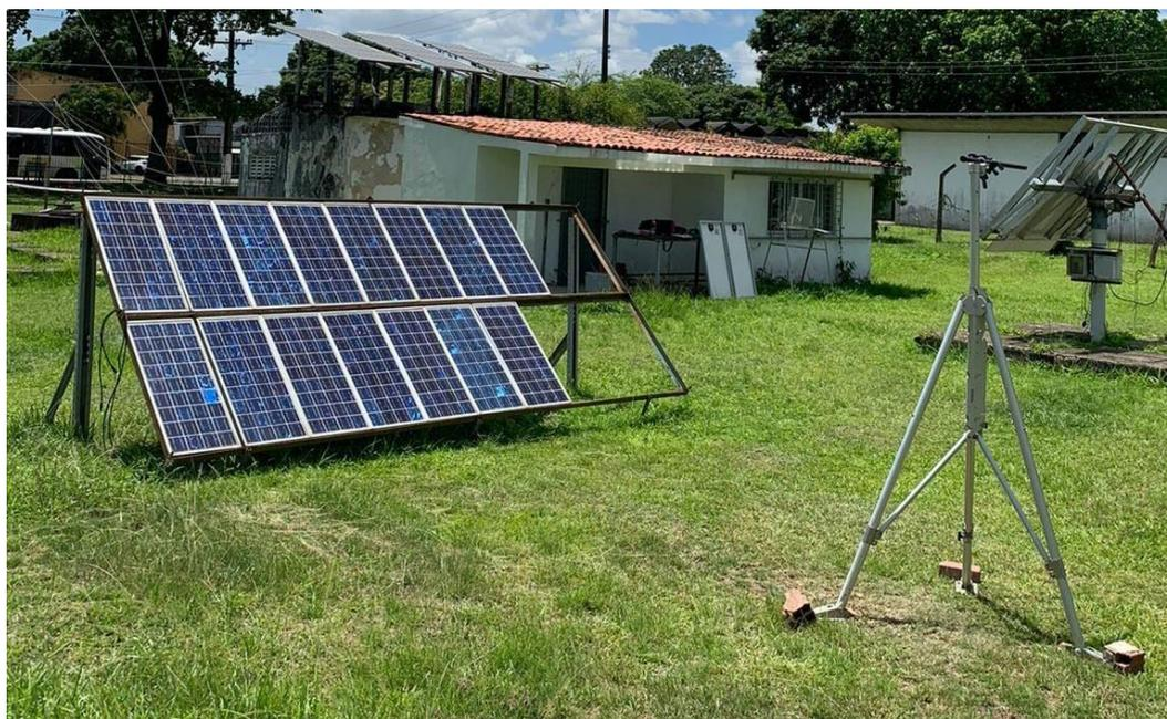
Arranjo em série com módulos Photowatt® com tripé de sustentação (Experimento 3).
