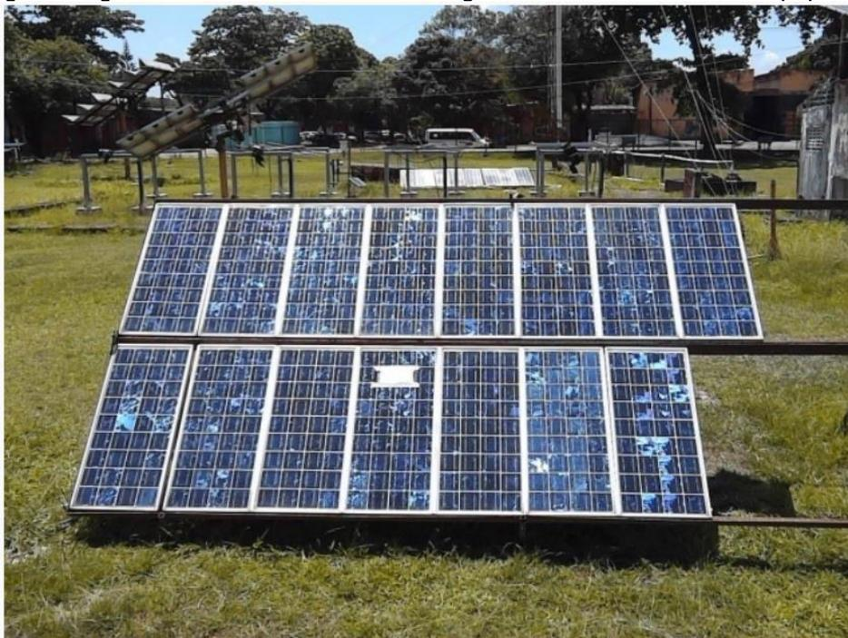
Imagem frontal retirada em solo dos módulos Photowatt® para aferição da temperatura média refletida frontal (T<sub>MRF</sub>).
