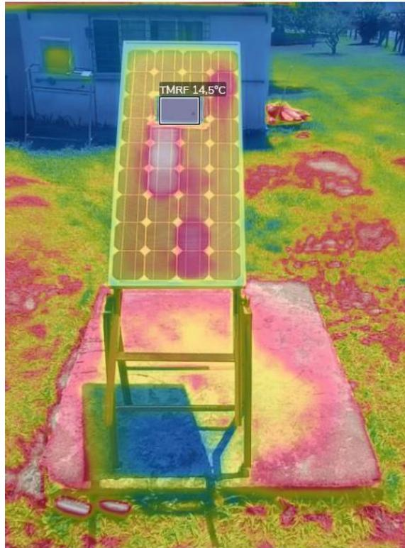
Imagem IV retirada a punho da frente do módulo para aferição da temperatura refletida média frontal ( $T_{MRF}$ ).
