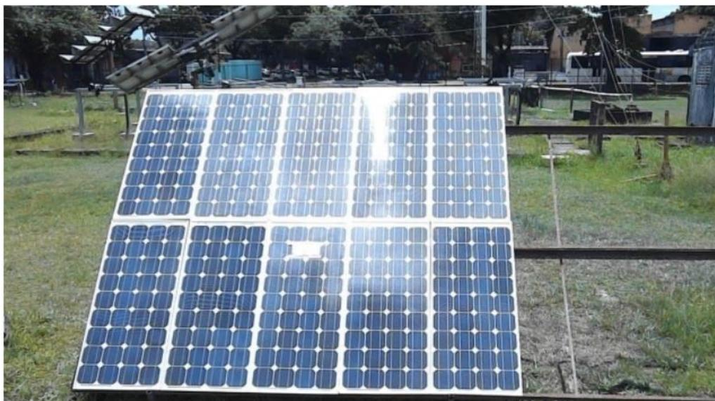
Imagem retirada em solo frontal dos módulos Isofotón<sup>®</sup> para aferição da temperatura refletida ( $T_r$ ).
