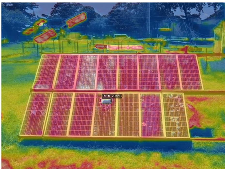
Termograma retirada em solo frontal de módulo Photowatt® para aferição da temperatura média refletida frontal (T<sub>MRF</sub>).
