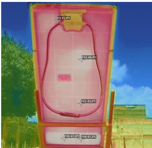
Imagem retirada a punho da traseira do módulo com emissividade calibrada.
