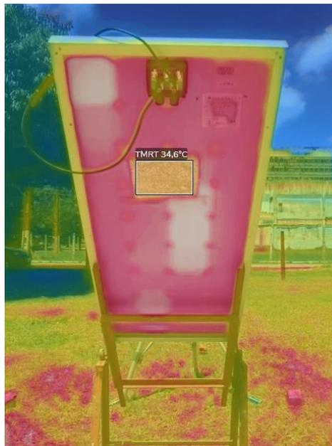
Termograma retirado a punho às 11:40h da traseira do módulo para aferição da temperatura média refletida traseira (TMRT).
