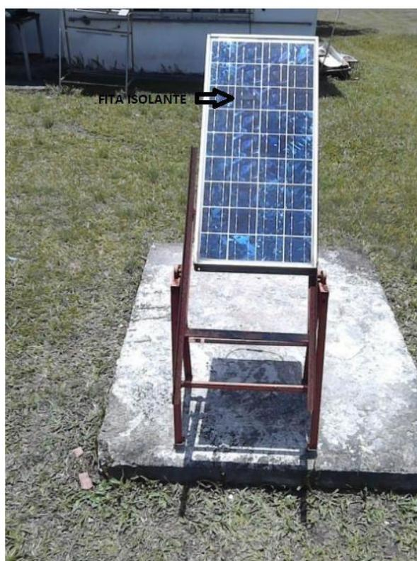
Fita para calibração da emissividade (seta preta vazada) afixada na célula 10 do módulo.
