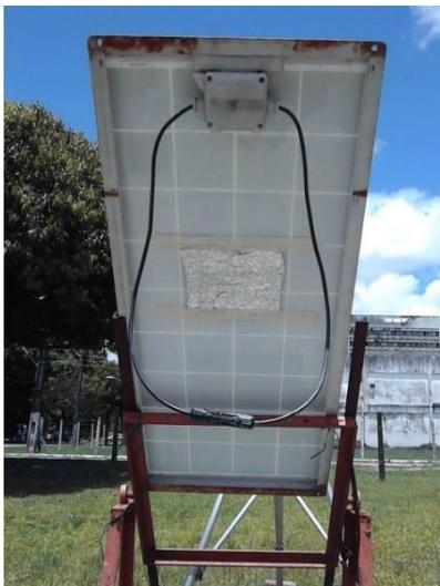
Imagem da parte traseira retirada a punho da parte traseira do módulo com papel alumínio afixado para aferição da temperatura refletida média traseira ( $T_{MRT}$ ).
