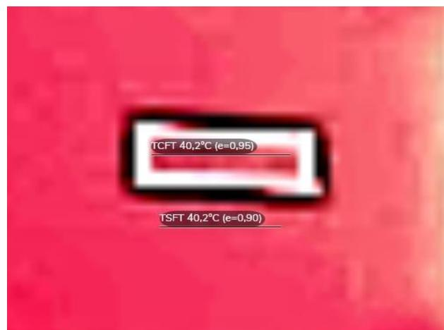
Termograma retirado a punho aproximado da célula da parte traseira do módulo para aferição da temperatura na fita ( $e = 0,95$ ).
