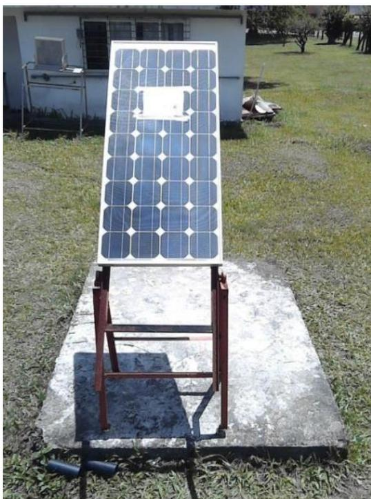
Imagem fotográfica retirada a punho da frente do módulo para aferição da temperatura refletida média frontal ( $T_{MRF}$ ).
