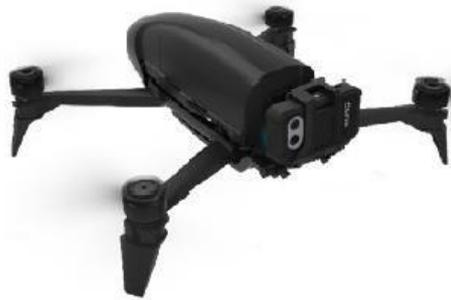
Drone com câmera Flir® One Pro acoplada.
