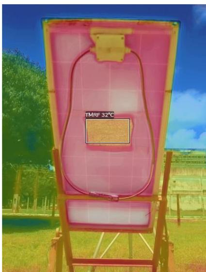
Termograma obtido a punho da parte traseira do módulo com papel alumínio afixado para aferição da temperatura refletida média traseira ( $T_{MRT}$ ).
