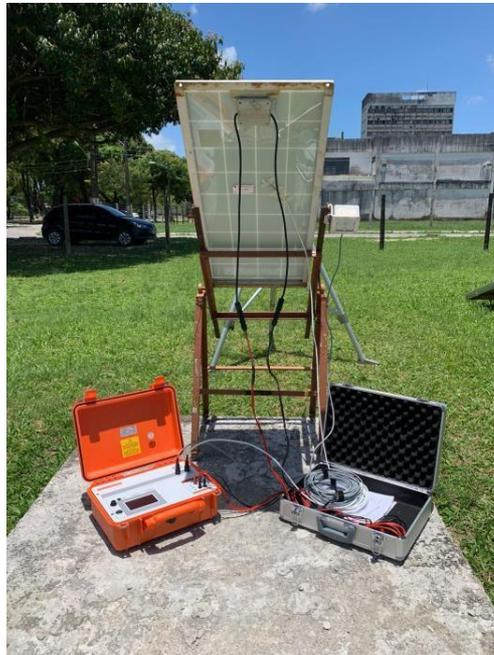
Arranjo apresentando módulo, Solarímetro e traçador de curvas IxV em arranjo isolado.
