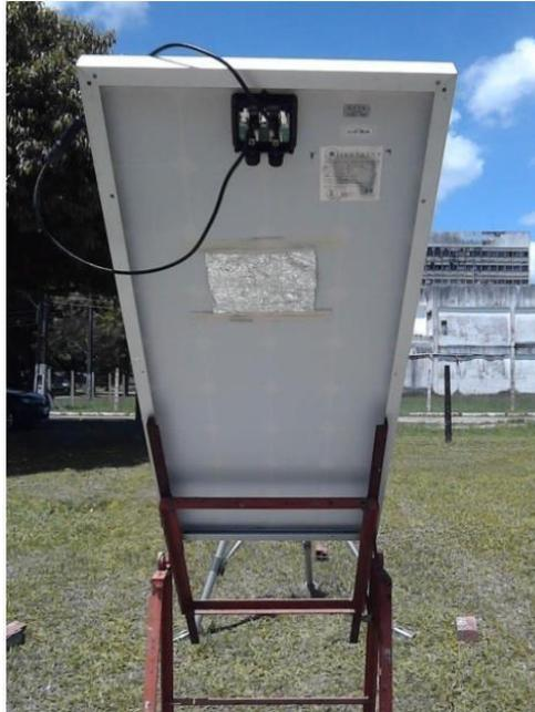
Imagem retirada a punho da traseira do módulo para medição da temperatura refletida ( $T_r$ ).
