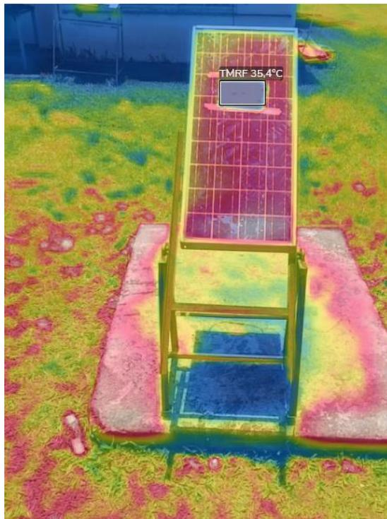
Termograma do módulo retirada em solo com papel alumínio afixado na parte frontal do módulo, para aferição da temperatura média frontal ( $T_{MRF}$ ).
