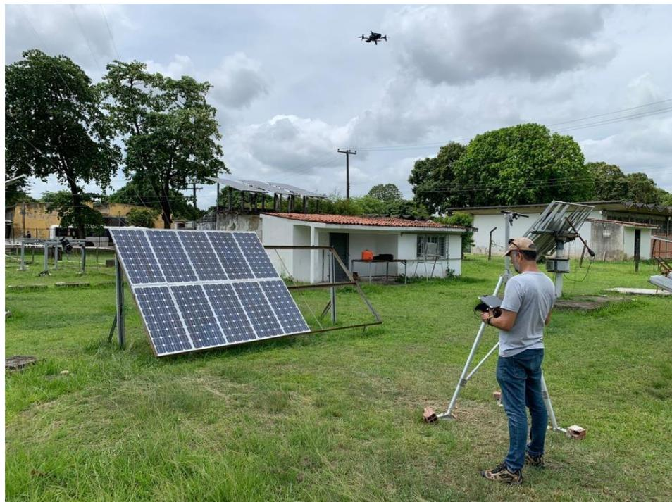
Termografia utilizando-se drone realizada no arranjo com módulos em série.
