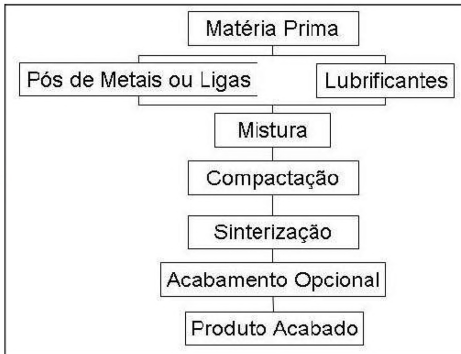
Figura 3 – Fluxograma do processo de Metalurgia do Pó.
