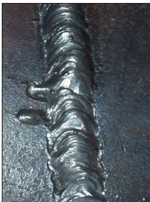
Figura 5.2 – Detalhe do cordão de solda a arco elétrico com eletrodo revestido (abril, 2001).
