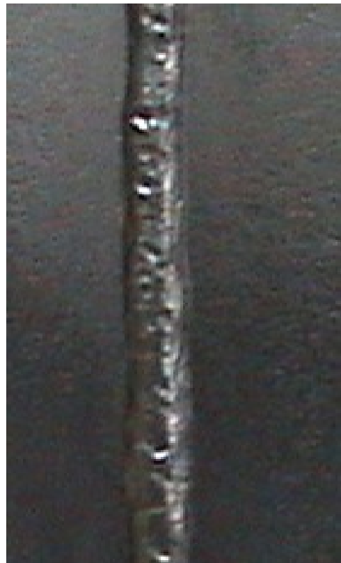
Figura 9.9 - Cordão de Solda pelo processo MAG após a reengenharia (raiz da solda)
