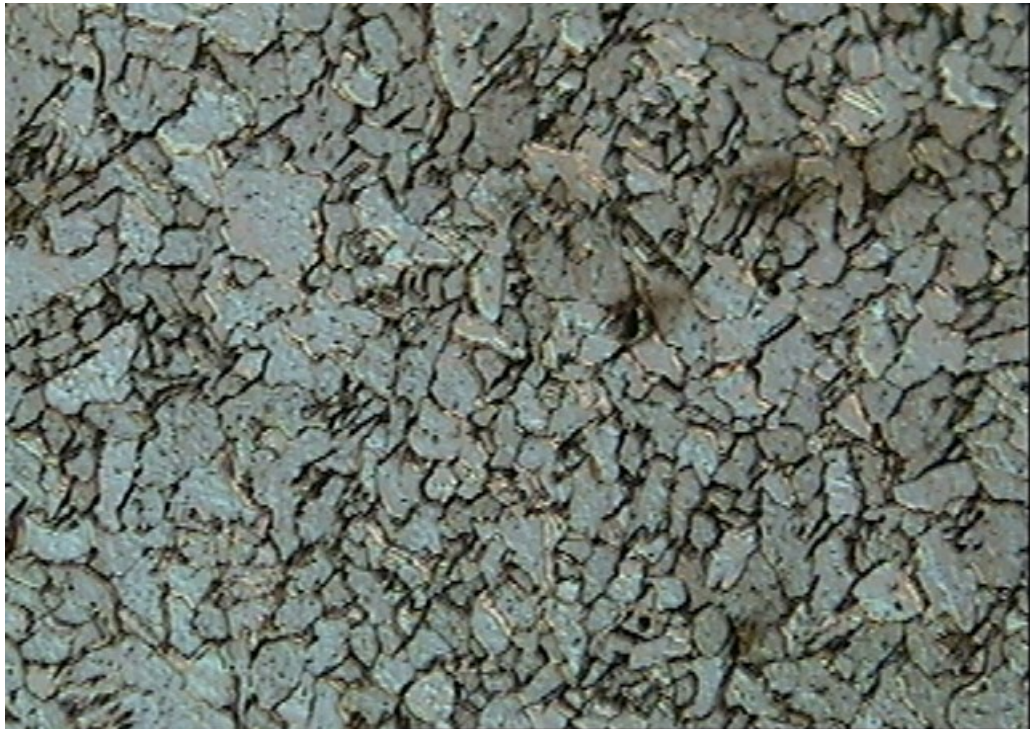
Figura 9.22 – Zona de parcialmente transformada (300x)
