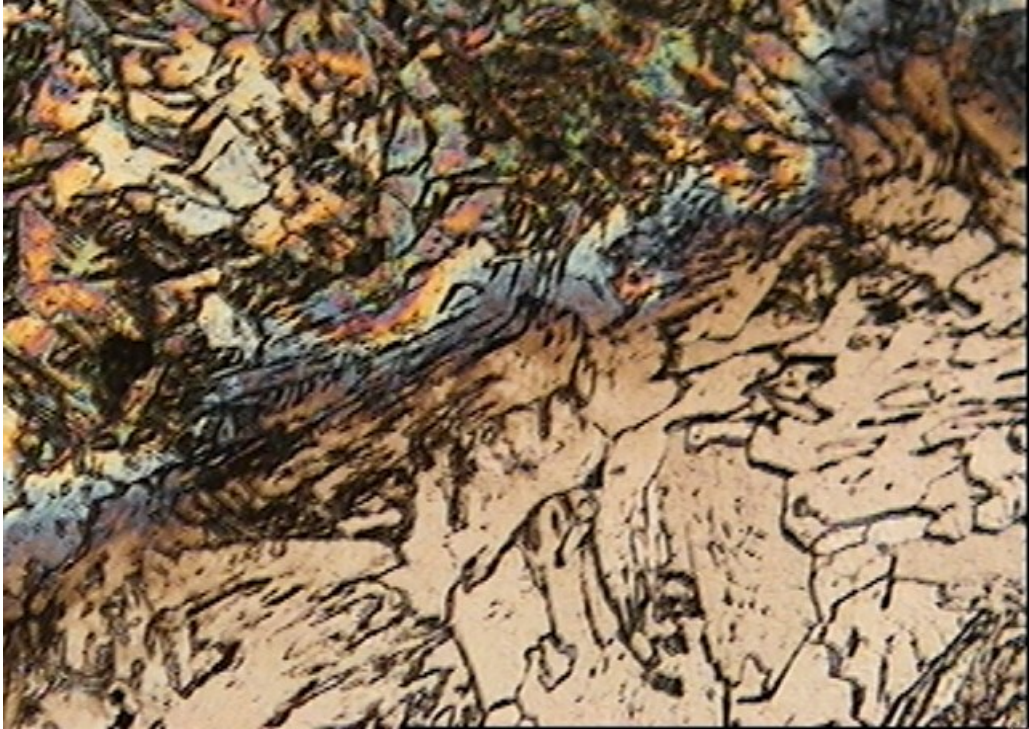
Figura 9.20 – Microestrutura da zona ligação (300x)
