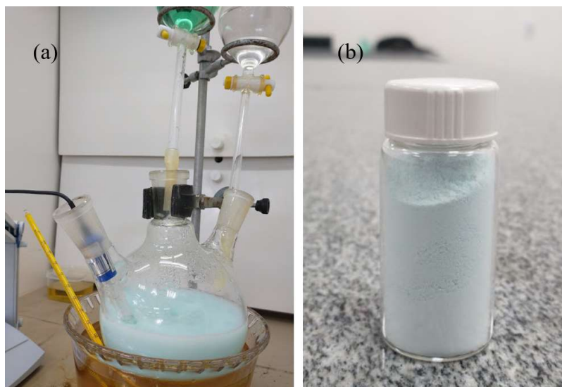
Figura 3 - (a) Síntese do precursor \text{Ni}_{0,2}\text{Al}_{0,8} -HDL. (b) Produto após maceração.
