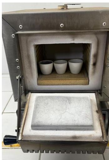
Figura 10 - Teste de umidade do pó realizado na mufla a 600°C, sendo avaliado para diferentes intervalos de tempo.
