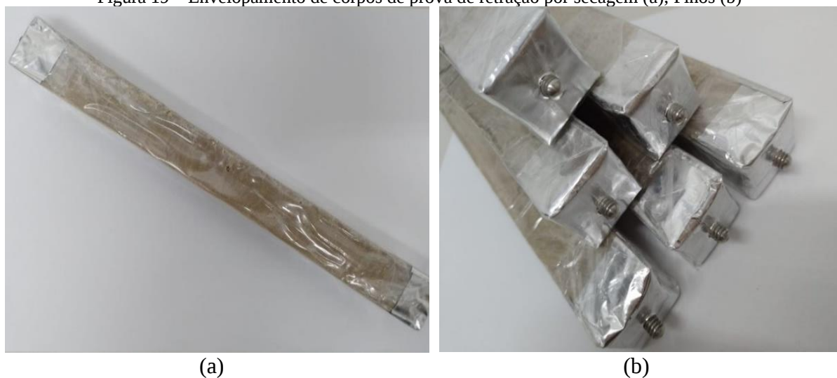
Figura 19 – Envelopamento de corpos de prova de retração por secagem (a); Pinos (b)
