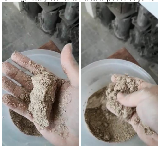
Figura 13 – Argamassa produzida com substituição de areia por vermiculita.
